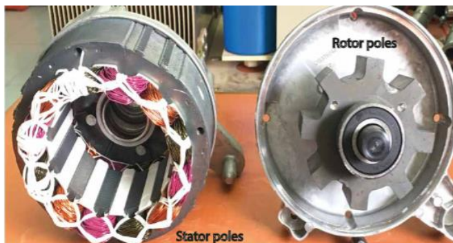
Figura 1. SRM trifásico de 12 polos estatóricos y 8 polos rotóricos.
