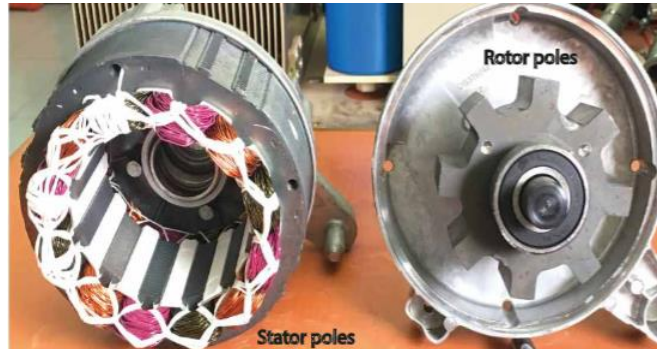
Figura 1. SRM trifásico de 12 polos estatóricos y 8 polos rotóricos.
