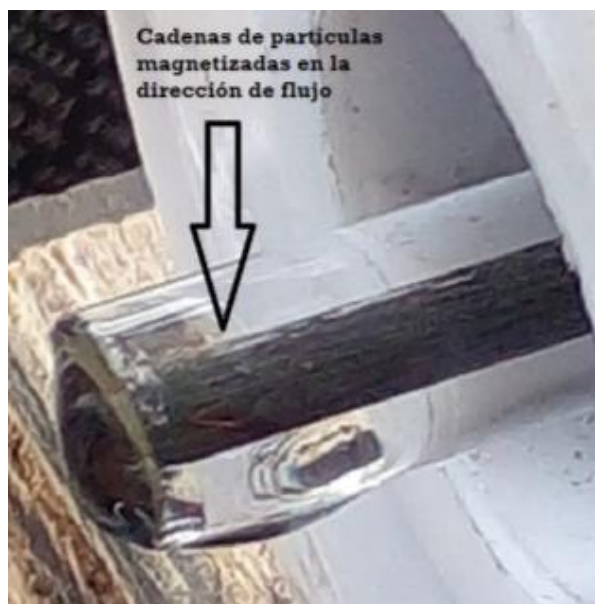
Figura 4. Fotografía de la formación de cadenas de las partículas magnetizadas en la dirección de flujo.
