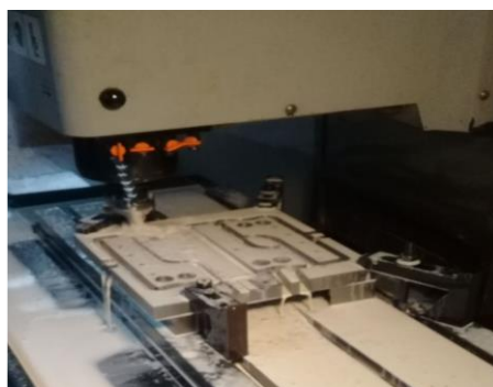
Figura 6.0.- maquinado en control numérico de portacuchillas.
