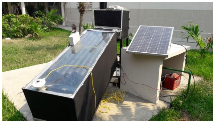
Figura 2 – Deshidratador solar. (Propiedad del Laboratorio de Sistemas Energéticos, Facultad de Mecánica y Ciencias Navales de Universidad Veracruzana campus Boca del Río).
