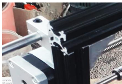
Figura 4. Perfil de aluminio empleado
