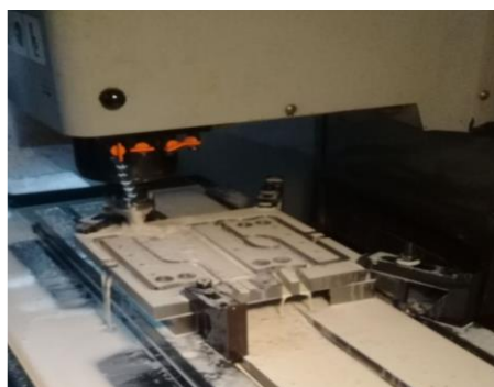
Figura 6.0.- maquinado en control numérico de portacuchillas.
