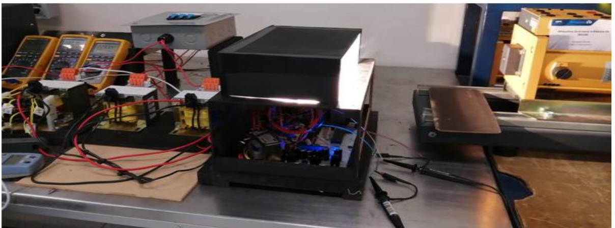
Figura 7. Arreglo de transformadores monofásicos, y la carga en el desarrollo de la adquisición de valores.
