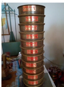
Figura 2.- Montaje de mallas para el análisis granulométrico y tabla de abertura de malla
