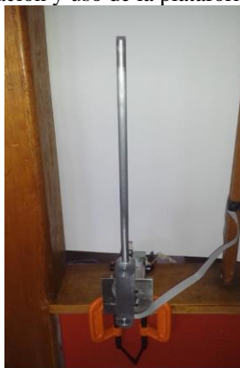
Figura 2. Plataforma educativa basada en un robot Pendubot.
