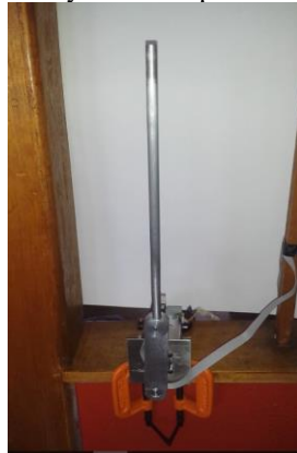
Figura 2. Plataforma educativa basada en un robot Pendubot.
