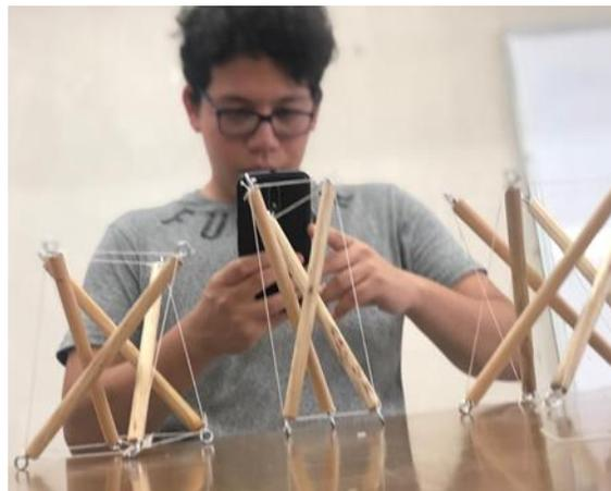
Figura 9. Prototipos de simplex de 6,8 y 10 nodos.
