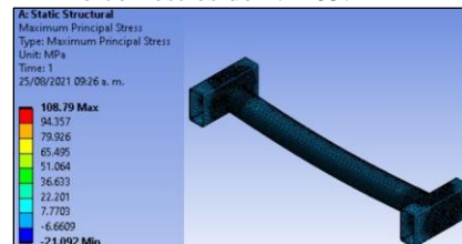
Figura 6 Máximo estrés principal rodillo
