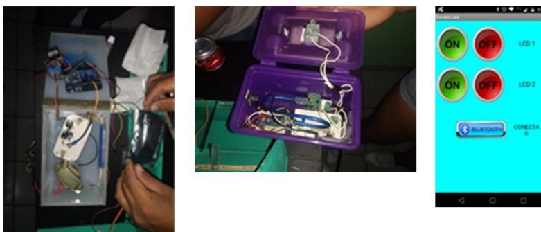
Ilustración 7 Conexión Arduino uno, Arduino nano y servomotores; Conexión Arduino nano y Bluetooth y Accionamiento vía Bluetooth
