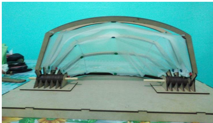
Figura 10. Cascarón plegable con membrana, vista frontal. (Martagón, 2019).
