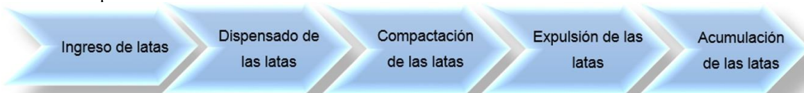
Ilustración 11 Proceso general del Prototipo Compactador Sustentable de Latas de Aluminio
