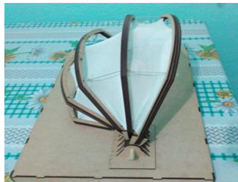
Figura 9 Cubierta con la membrana colocada en cada arco (Martagón, 2019)
