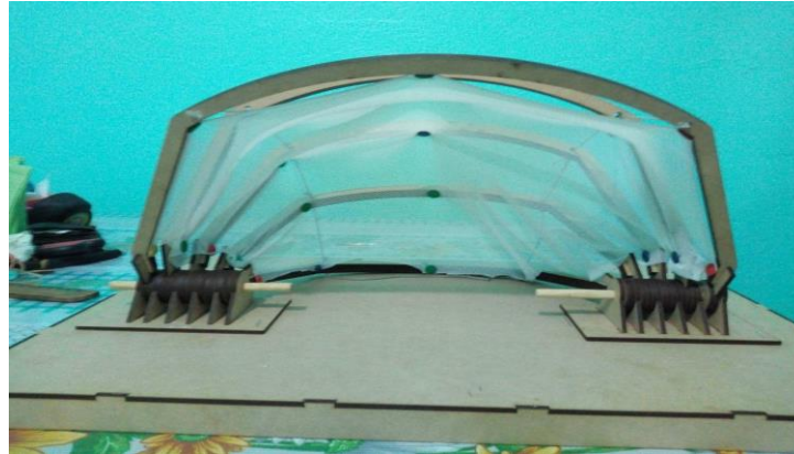
Figura 10. Cascarón plegable con membrana, vista frontal. (Martagón, 2019).
