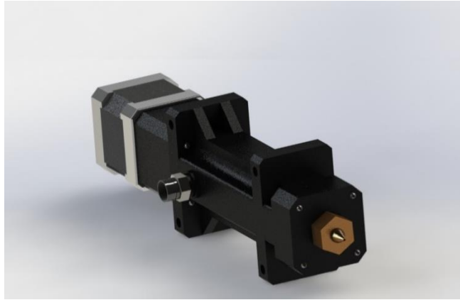
Figura 3. Diseño del extrusor de cera – Vista Isométrica
