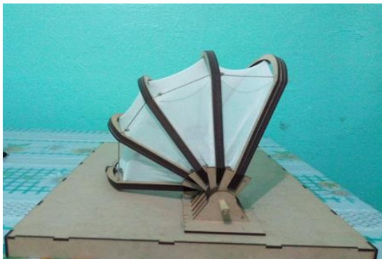
Figura 8 Cubierta con la membrana colocada en cada arco (Martagón, 2019)
