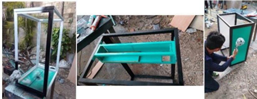
Ilustración 4 Pintura a la estructura, base y triplay
