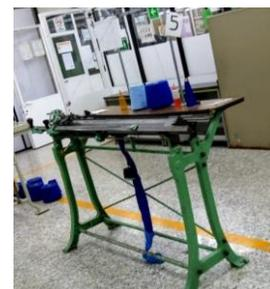
Fig. 10. Máquina manual rectilínea Diaman galga 12.
