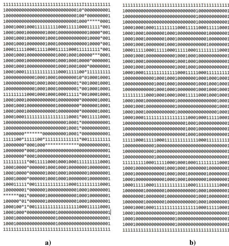
Fig. 2. Entorno de búsqueda a) Entorno con solución A*, b) Entorno sin solución
