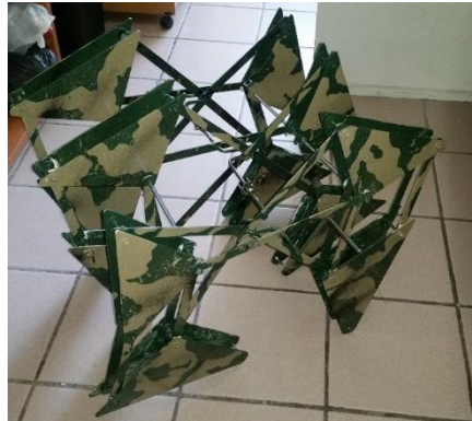
Figura 2. Primer prototipo basado en el mecanismo caminante de Theo Jansen.
