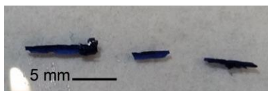
Figura 6. Cristales de cobalto-tiourea con asistencia UV-C.
