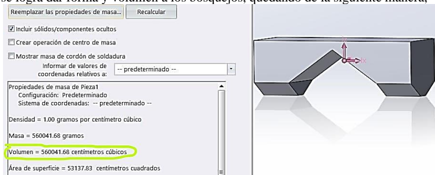
Figura No. 5. Cálculo del volumen de la tolva.
