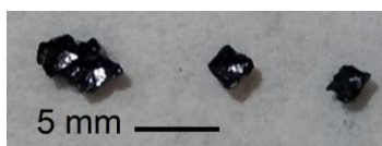
Figura 4. Cristales de cobalto-tiourea sin asistencia UV-C.
