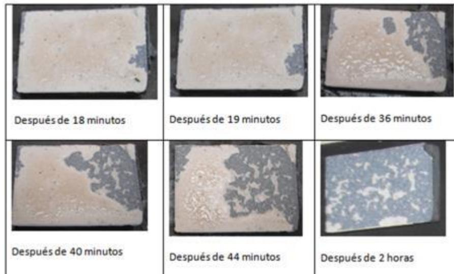
Figura 3. Proceso de desprendimiento de capa cerámica
