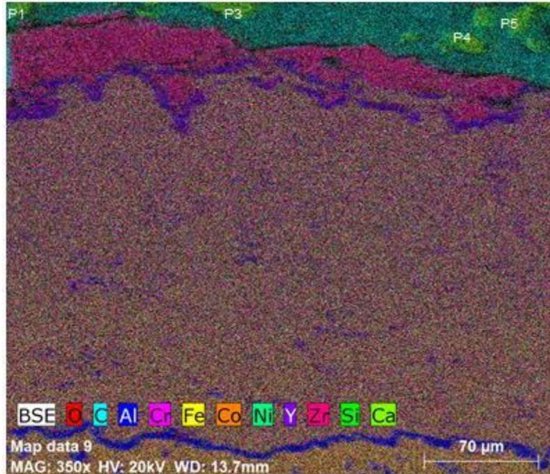
Figura 4. Mapeo de sección transversal de la TBC sometida a 1200°C durante 24 h, con una carga de 35 mg/cm<sup>2</sup>.
