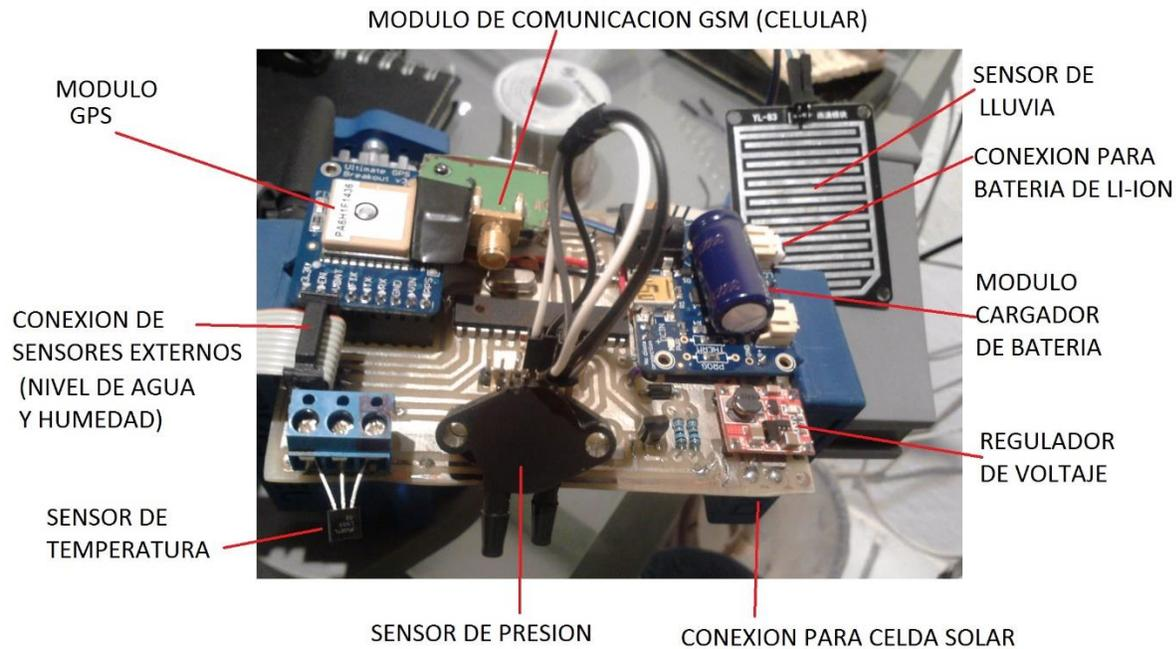
Figura 5. Foto del prototipo antes de ensamblarse dentro de la caja protectora.
