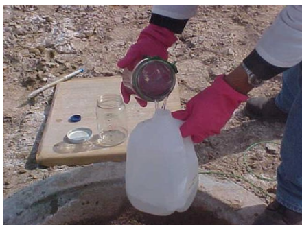
Figura 1. Muestreo de las aguas residuales
