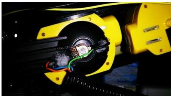
Figura 3. Elemento sensor en una articulación del brazo de robot
