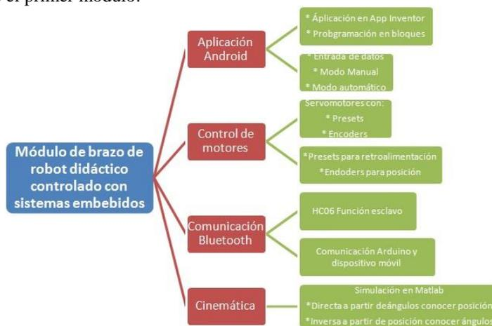
Figura 1. Esquema general del sistema para el control del brazo de robot
