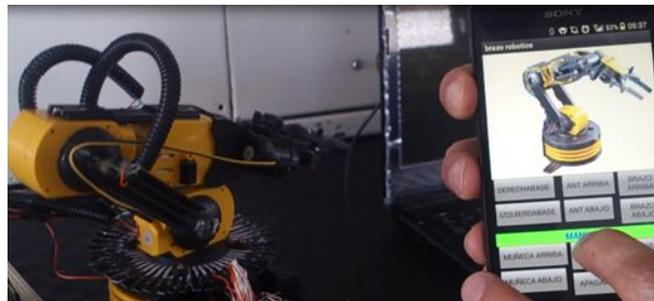
Figura 7. Movimiento del brazo de robot, empleando la aplicación desarrollada en AppInventor
