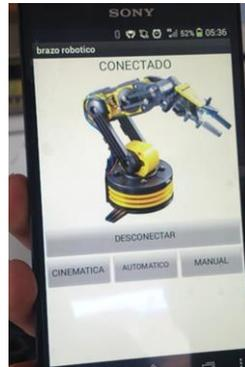
Figura 6. Desarrollo de la aplicación con las opciones conectar, cinemática, manual y automático
