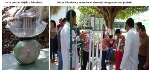
1ro se pesa el objeto a introducir. 2do se introduce y se recibe el desalojo de agua en una probeta.
