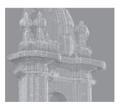
Fig. 5. Dibujo en AutoCad con el programa Cloudworx de los volúmenes generales de una estructura sobre una nube de puntos visualizada a baja densidad (Mañana P. *et al.*, 2008).
