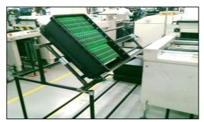
Fig. No.6 Los racks utilizados después de kaizen
