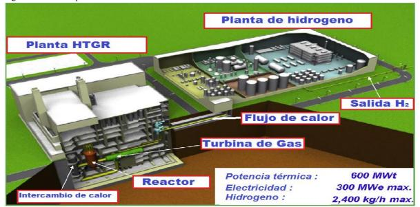
Figura 2 Diagrama de reactor HTGR
