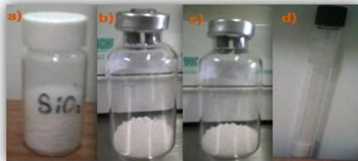
Foto 1. Polvos obtenidos: a) \text{SiO}_2 , b) \text{SiO}_2\text{-DA} 10%, c) \text{SiO}_2\text{-DA} 15%, d) \text{SiO}_2\text{-DA} 20%
